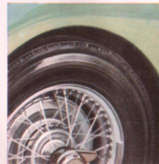
Le modèle standard est équipé de roues à disque en acier avec orifices de ventilation, mais pour une circulation à vive allure ou pour les compétitions, l'utilisation des roues à rayons d'acier avec moyeu à blocage à vis est recommandée.
