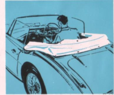
Das dauerhafte, kunstlederne Faltdach und die Kurbelfenster können leicht und schnell bedient werden. Dadurch ist der CONVERTIBLE ein echter Allwetterwagen geworden. Eine zusätzliche Entlüftung läßt sich durch das einfache Entfernen der flexiblen Heckscheibe erreichen.
